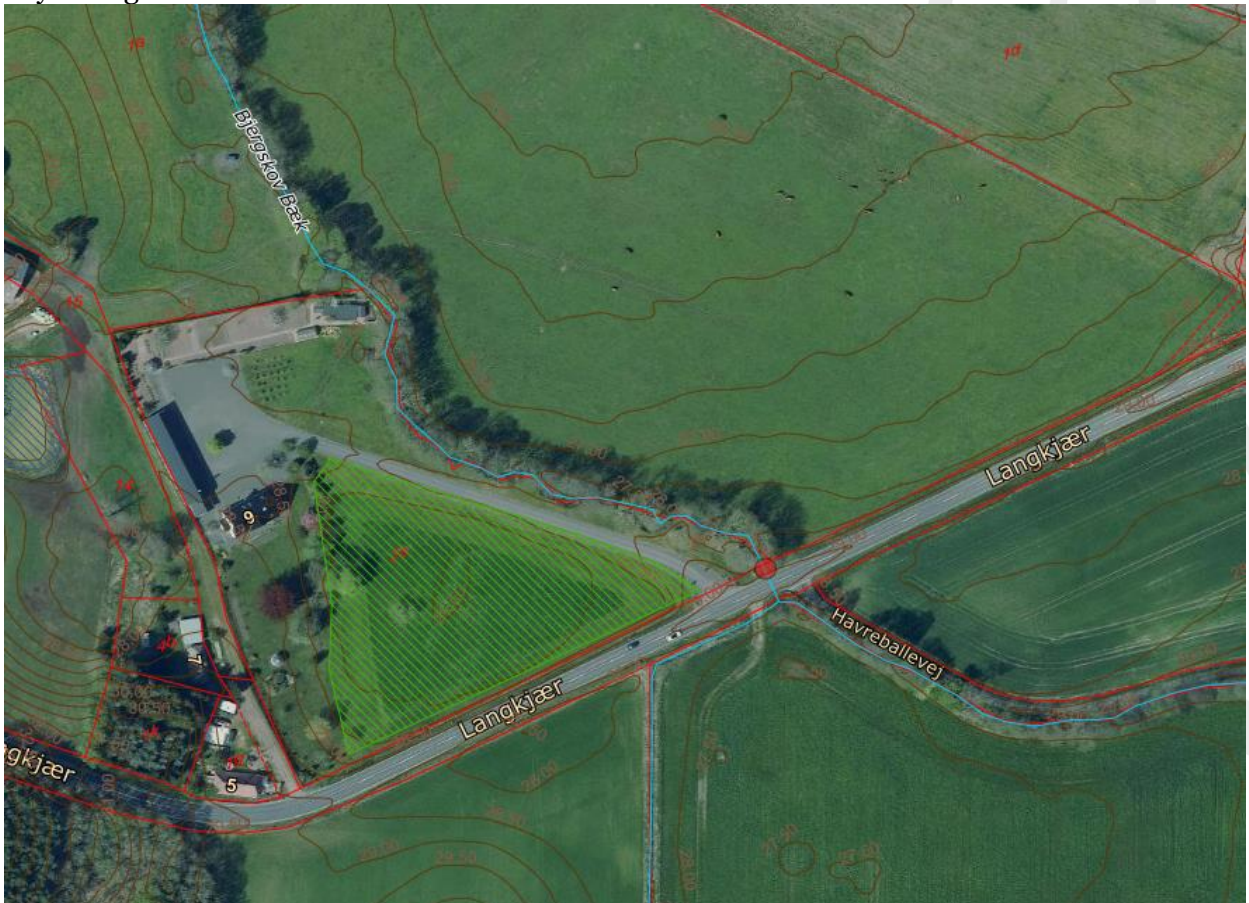
Figur 1: Krydsningspunkt, Bjergskov Bæk. Krydsningen sker i matrikel 7000b Hem By, Voerladegård ved styret underboring. Det skraverede område er vejledende udpeget som beskyttet eng iht. naturbeskyttelseslovens §3.
